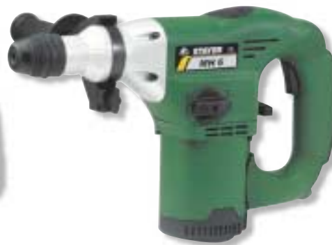
MARTILLO ELECTRONEUMÁTICO MH 6 K STAYER Martillo combinado. Potencia 1020 W. 0-800 r.p.m. Capacidad máxima 24 mm. de diámetro. SDS Plus. 0-3200 r.p.m. 3 funciones. Set de 5 brocas SDS máx. + 2 cinceles SDS Plus con maletín. 89,95 € ref. 86.566
