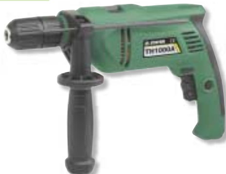
TALADRO PERCUTOR TH1000A STAYER Potencia 1.000 W. Giros en vacío 0-2.800. Percusión 0-44.800. Portabrocas 13 mm. Capacidad de corte en madera 25 mm., en acero 10 mm. y en aluminio 20 mm. Inserción portabrocas 1/2"x20. Peso 2,3 Kg. 52,95 € ref. 86.565
