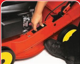
ajuste centralizado de las alturas de corte
