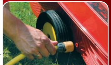
empalme para la limpieza con chorro de agua (en los modelos de 48 cm)
