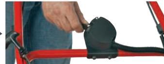
arranque con llave de contacto (en los modelos NTEB5 y GTEB5M)
