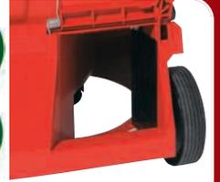
postigo abierto: corte con expulsión trasera o recogida
